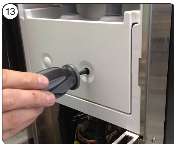
Ajustar el Flujo de Agua Usando Un Destornillador Plano
