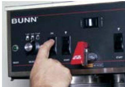
8. Ponga el interruptor de encendido/apagado en la posición superior encendida.
