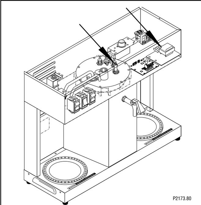
FIG. 12 LIQUID LEVEL PROBE & CONTROL BOARD
